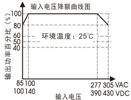
注：①对于输入电压为 85-100VAC/277-305VAC/100-140VDC/390-430VDC，需在温度降额的基础上进行电压降额；
