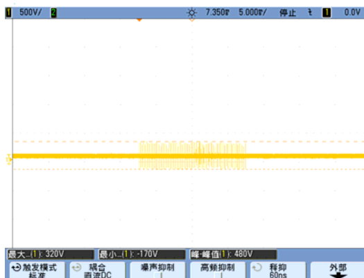
经过抑制器处理后的输出扰动电压
