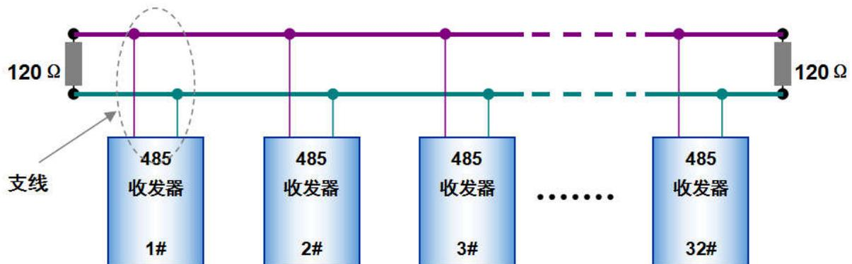
图 1-2 RS485 总线的简化连接方式
