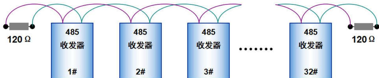
图 1-1 RS485 总线的连接方式与终端电阻
