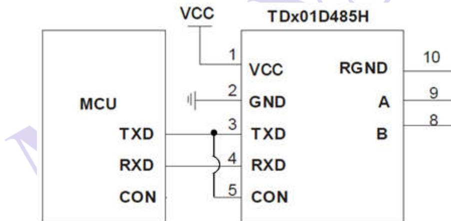
图 2-3 省略 CON 脚控制脚的接线应用图
