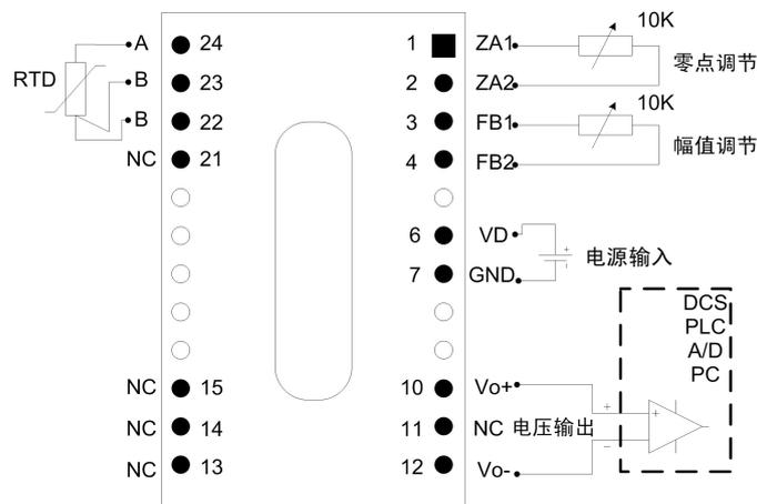
图 3 电压输出型产品应用接线图
