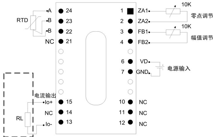
图 2 电流输出型产品应用接线图
