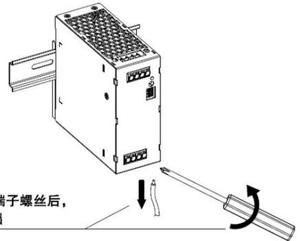
⑥用十字螺丝刀松开端子螺丝后，把导线从端子孔拔出
