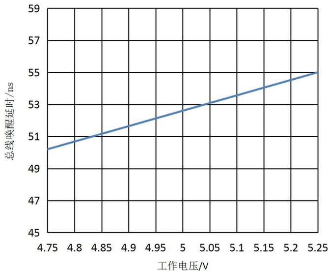
图3 总线唤醒延时 VS 工作电压
