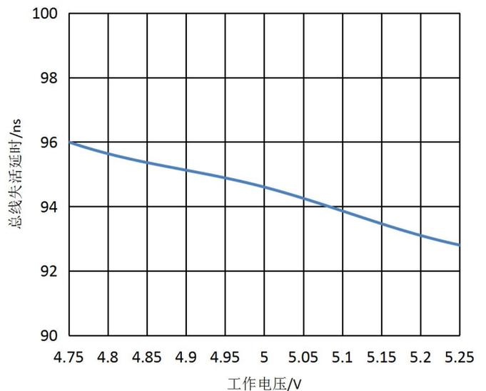
图4 总线失活延时 VS 工作电压
