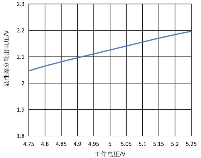
图2 显性差分电压 VS 工作电压
