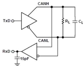
图10. 传输特性测试电路
