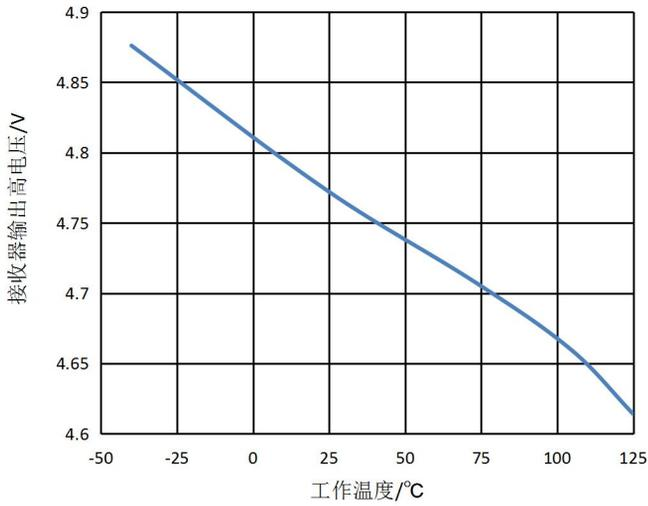
图5 接收器输出高电平 vs. 工作温度
