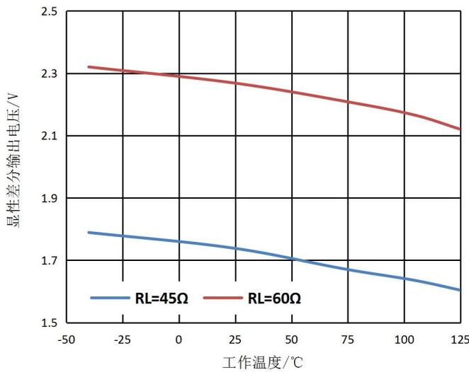
图1 显性差分电压 VS 工作温度
