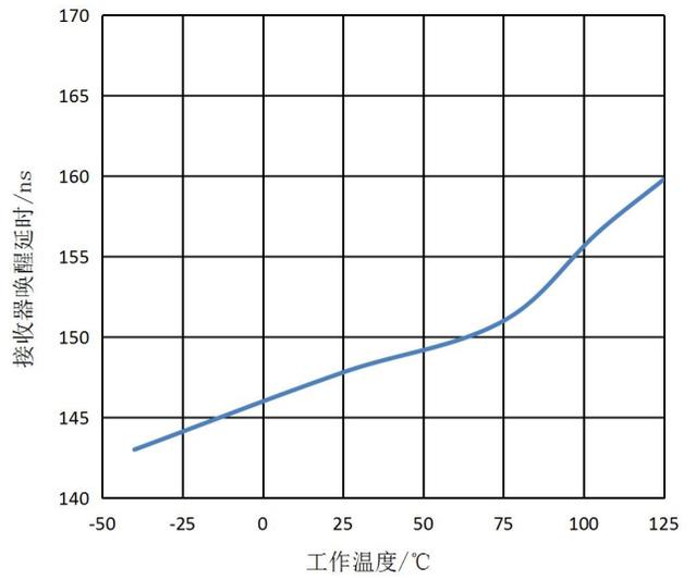
图6 接收器唤醒延时 vs. 工作温度
