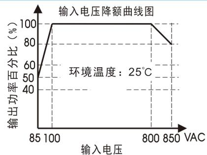
注: ①对于输入电压为 85-100VAC, 800-850VAC, 产品需在温度降额的基础上进行电压降额;
