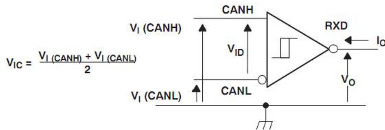
图 5 接收器电压与电流定义
