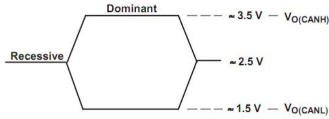
图 2 总线逻辑电压定义
