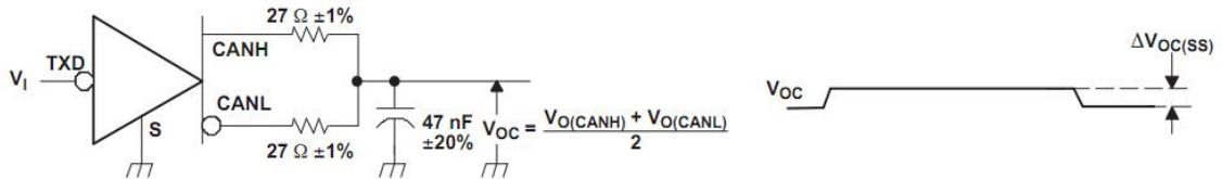
注：VI 从 0~VCC，输入脉冲产生器特点：PRR≤125KHz，50%占空比，tr<6ns，tf<6ns，Zo=50Ω
