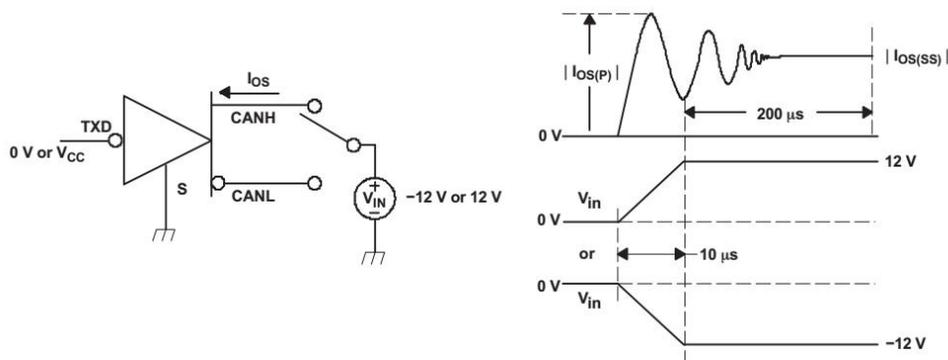
图 11 驱动器短路电流测试电路与波形
