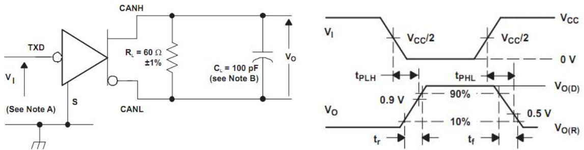
图 4 驱动器测试电路与电压波形
