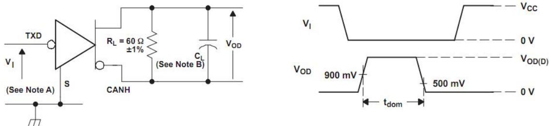
图 10 显性超时测试电路与波形
