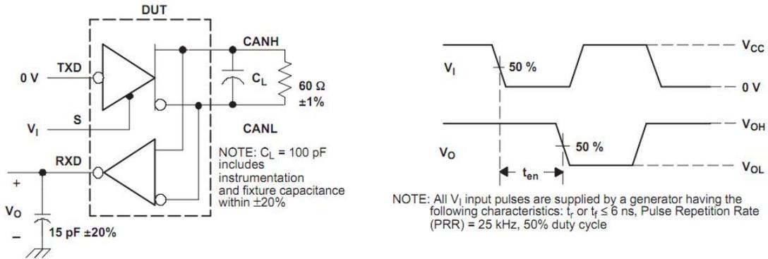
图 7 tEN 测试电路与电压波形
