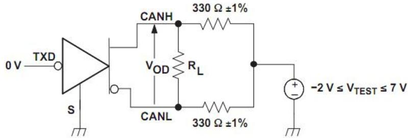
图 3 驱动器 VOD 测试电路
