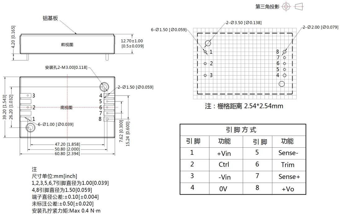
外观尺寸、建议印刷版图（带散热片）
