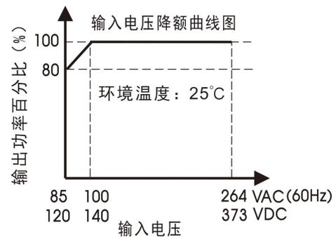
注：①对于输入电压为 85 - 100VAC/120 - 140VDC 需在温度降额的基础上进行输入电压降额；
